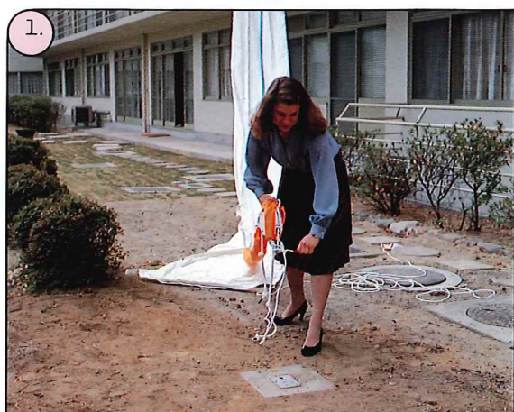
1. 誘導綱を除去し、袋先端のハッカーを下部固定金具へ、
